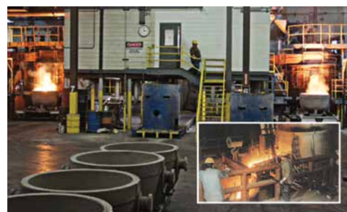
双电弧炉的高温冶金加工双倍产能有助于确保最大程度地回收废催化剂中剩余的铂族金属—包括铱。
