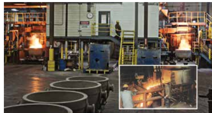
Los hornos duales de arco eléctrico duplican la capacidad de procesamiento pirometalúrgico, contribuyendo a asegurar la máxima recuperación de los remanentes de PGM's de los catalizadores gastados—incluyendo el renio.
