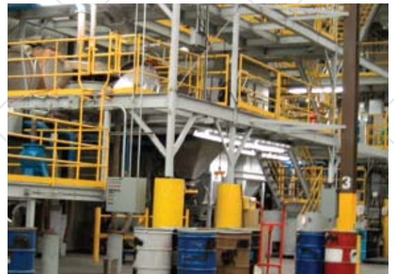
El sistema de muestreo automatizado Sabin captura los polvos generados durante el proceso para una subsecuente recuperación de metales preciosos.
