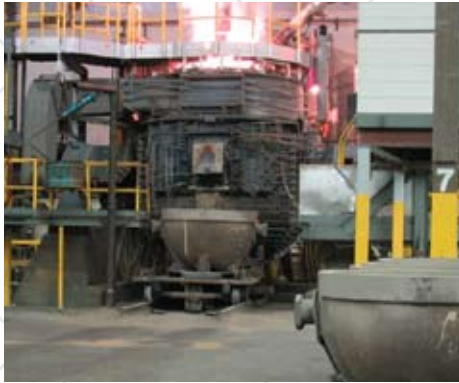
La tecnología de los hornos de arco eléctrico ayuda a maximizar la recuperación de metales preciosos en catalizadores gastados.
