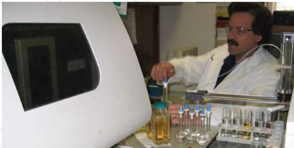
Espectroscopia de emisiones de plasma inductivamente conectada (ICP) para un exacto y preciso análisis de las muestras de metales preciosos; nuestro laboratorio también usa técnicas clásicas de volumetría, gravimetría y ensayo a fuego y técnicas avanzadas con equipo de Rayos X fluorescente y Absorción Atómica (AA).
